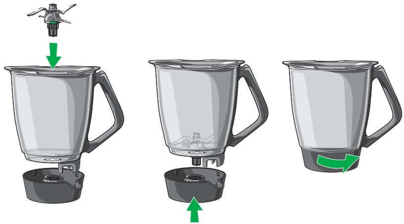
1. 请确保让搅拌刀组的密封圈位于刀组轴承下的合适部位并贴紧它。
